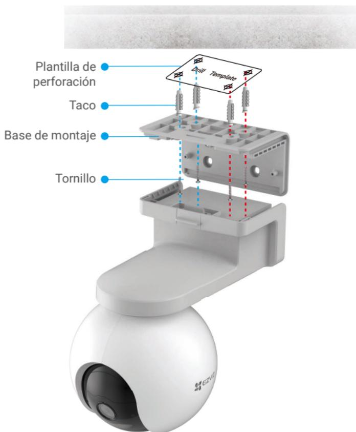
Figura 1. Montaje en techo
