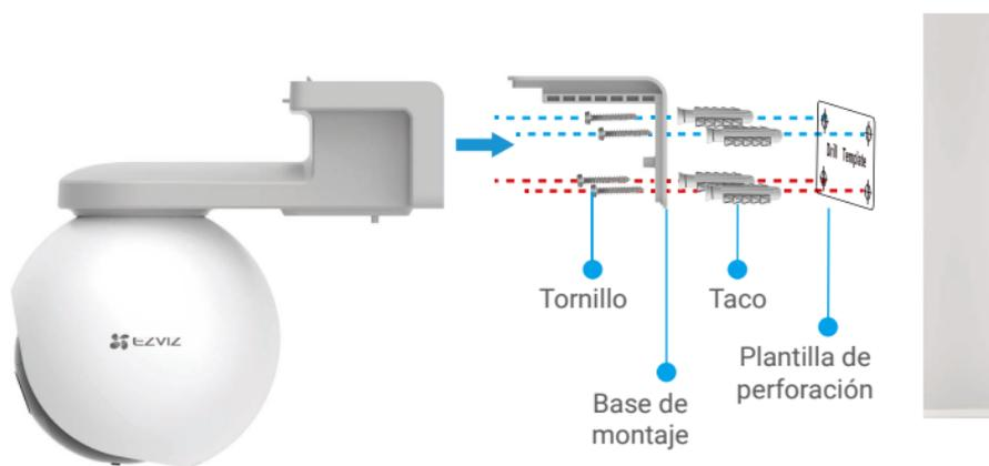
Figura 2. Montaje en pared
